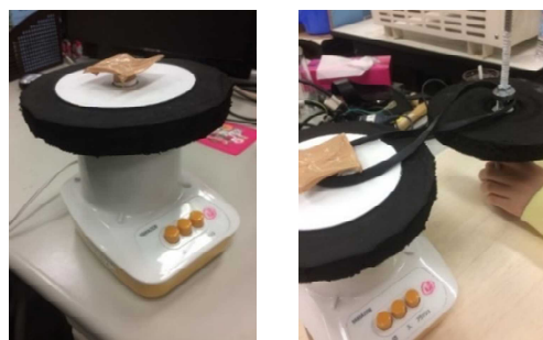
図3 モータを利用したシャトル発射装置
