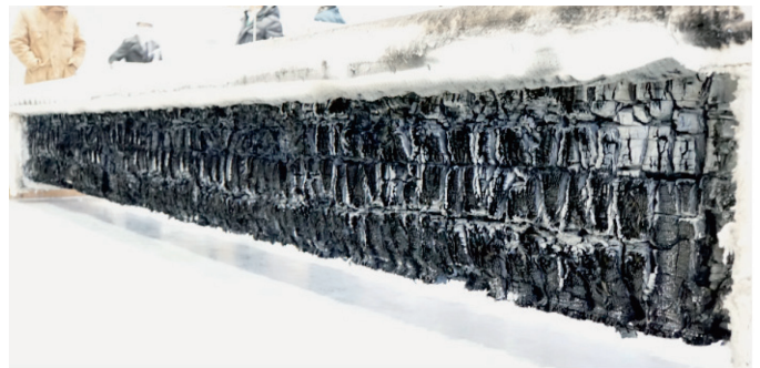
図 12 脱炉時の試験体の状況 (燃えしろ層 50 mm 側)
