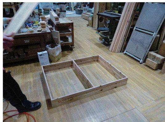
写真9 パネル枠の作成
