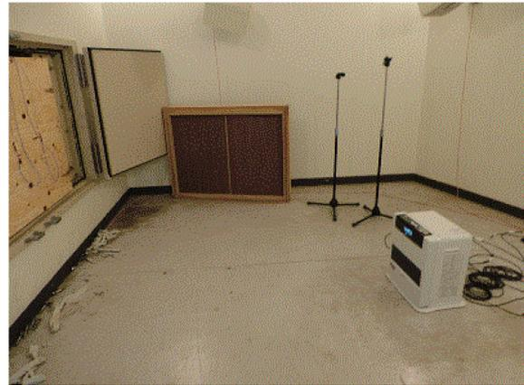
写真 13 音響室を利用した熱貫流率の測定
