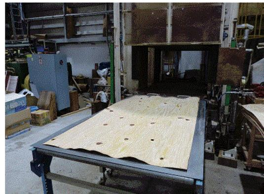
写真8 プレスみよる薄物合板の製造
