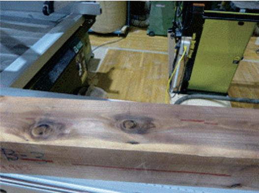
写真5 心持ち材の割れの様子(上：B-1、下：B-3)
