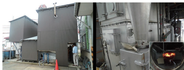
図2. I市のもみ殻燃焼実証機
