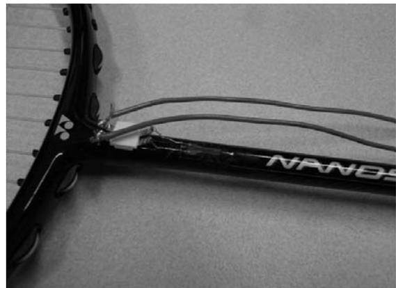
図1 ひずみゲージを貼付したバドミントンラケット（カーボンシャフトの先端近くの拡大写真）
