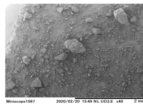
図 14. ミキサー粉碎「あきたさらり B」40倍 角が取れた粒子が多く、粒子の大きさもさまざま
