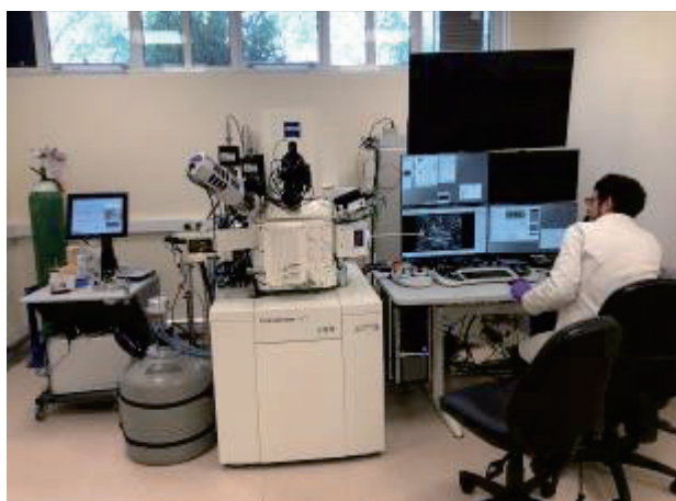
図4 最新の Cryo-FIB-SEM システム。
