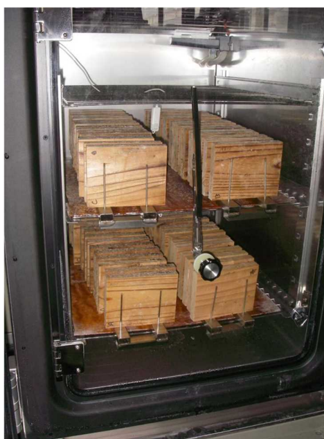
写真 3.1 高湿度雰囲気への放置中の試験体の状態
