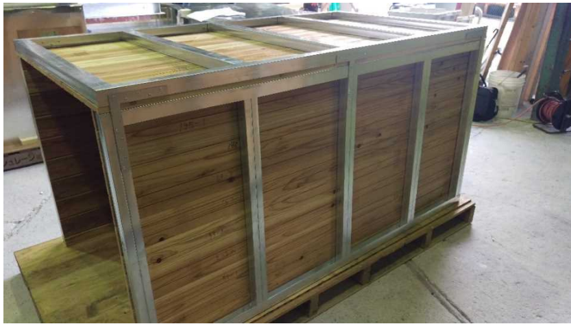
写真 4.4 箱状に組み立てたパネル
