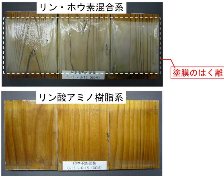
写真3 屋外暴露後の塗装試験体の状態
