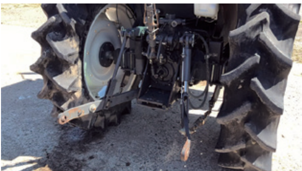
図6-5 作業機着脱の仕組み（トラクター側）.
