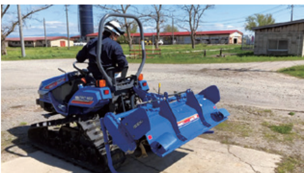
図6-7 オートヒッチによる作業機着脱.
