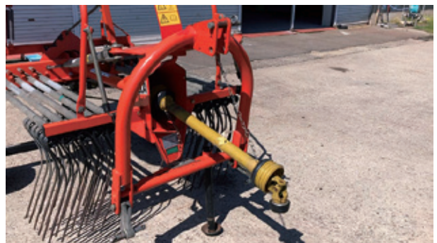
図6-6 作業機着脱の仕組み（作業機側）.
