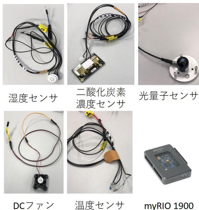
図 2. 容器内に配置したセンサと A/D 変換用の myRIO1900
