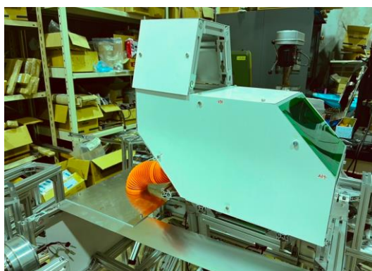
図3 切断して取り付けたアルミ板
