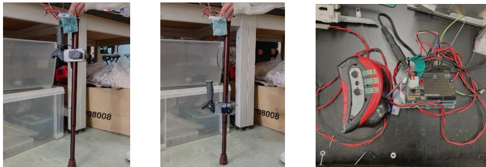
図6. 実際に使用することを想定した実験 左) 機構が上方にある場合 中) 機構が下方にある場合 右) モーターを動かすために繋げた回路とスイッチ
