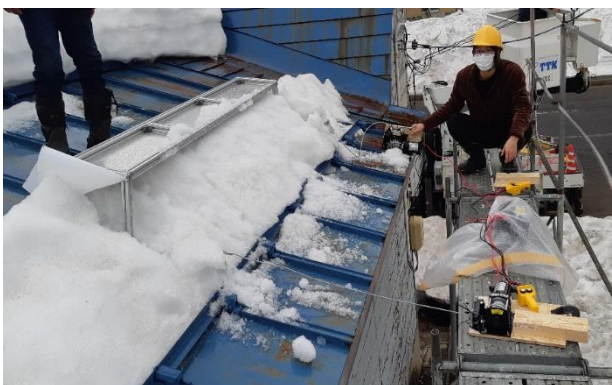
図4：引張試験時、固定木材が破断した際の写真
