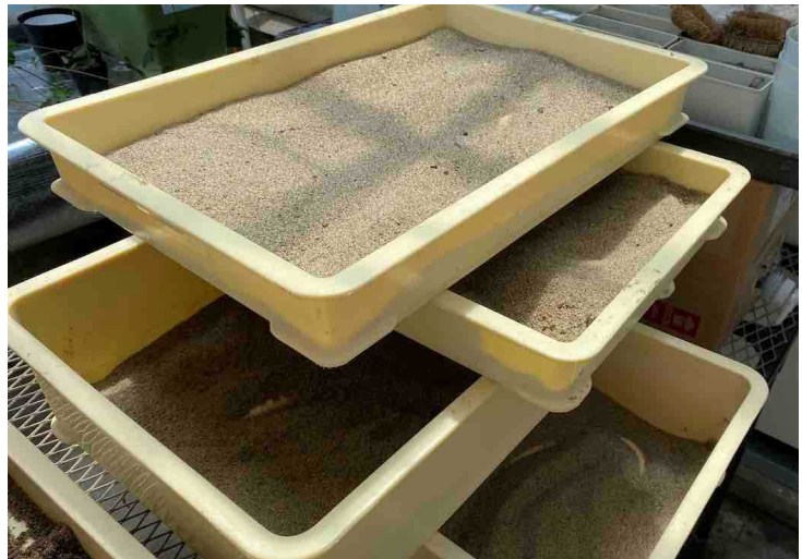
図1. 洗浄後に乾燥した砂質土壌
