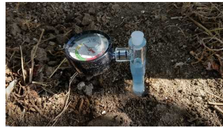
写真 2 土壌水分計を設置した様子
