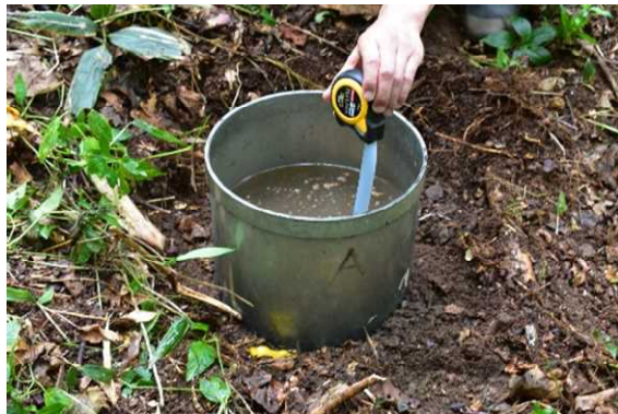
写真1. シリンダーインテークレート試験の様子
