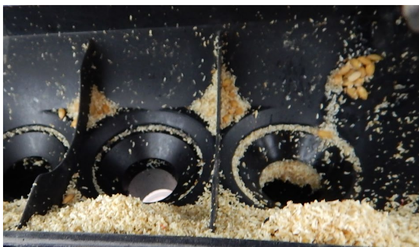
図 5-3 折損した幼芽 (繰り出しロール直下に折損した幼芽が堆積した様子。 損傷前の催芽種子の平均幼芽長は 1.4 mm であった。)
