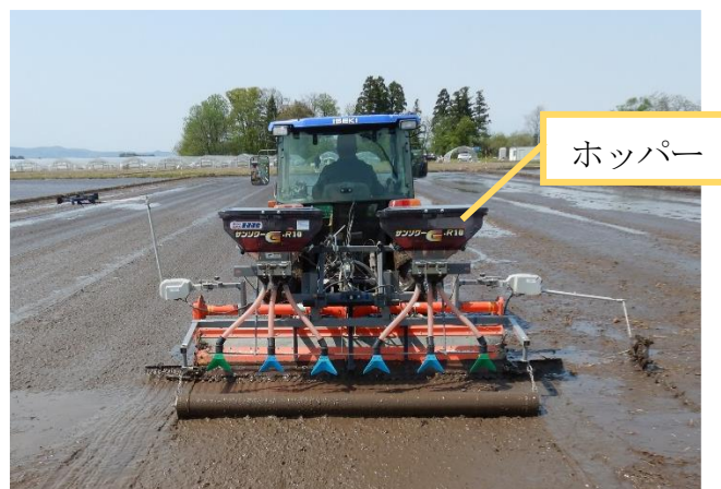
図 1-2 代かき同時浅層土中播種機
