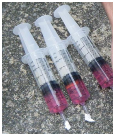
図 2-4 \text{DN}_2\text{O} 濃度測定用サンプルの現場での前処理
