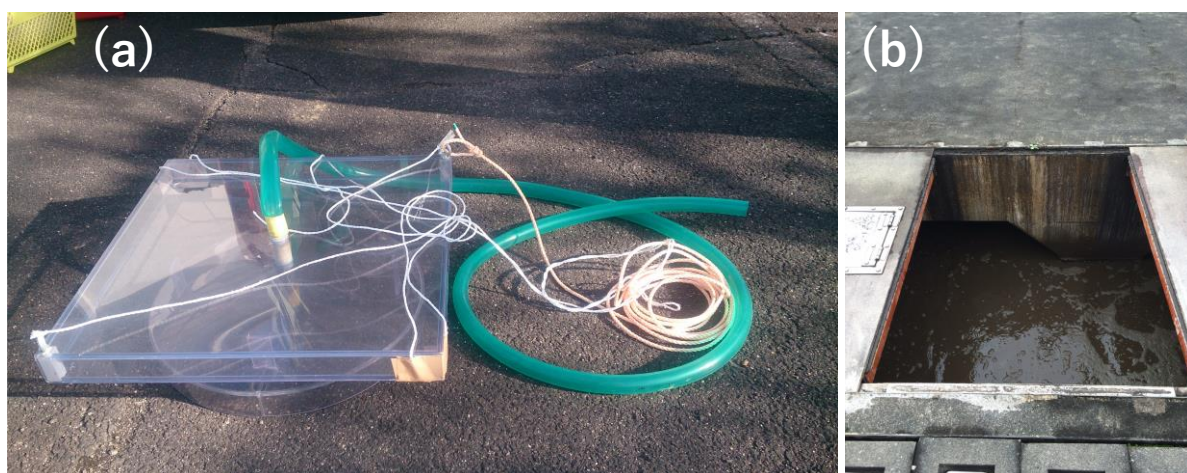
図 2-3 反応槽における GN 2 O サンプルの (a) 採取用チャンバー (b) 採取箇所
