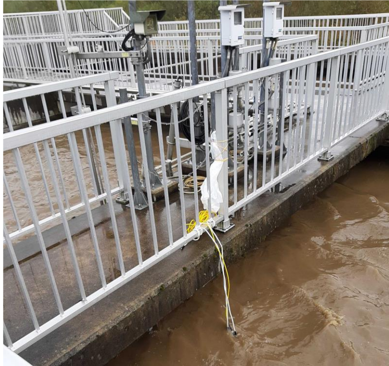
図 5 - 4 据え付け型 DO 濃度計器付近に浸漬させた蛍光式 DO 濃度センサー (図 5 - 1 参照)
