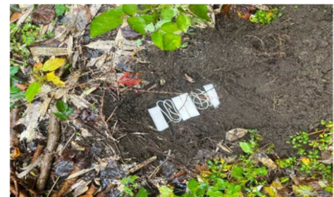
図6. 埋める前のプラスチックと目印としての発砲スチロール。
