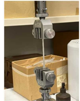
図4. 万能材料試験機(INSTRON)で引張り試験。
