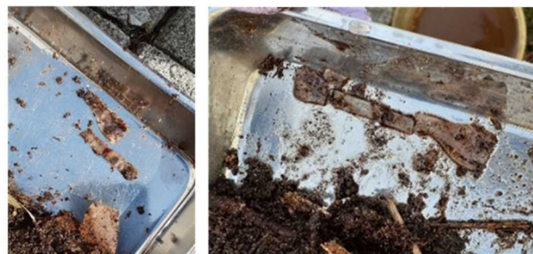
図8. 埋めてから2週間目。左が「あきたこまち」で、右が「まんぷくすらし」のプラスチック。
