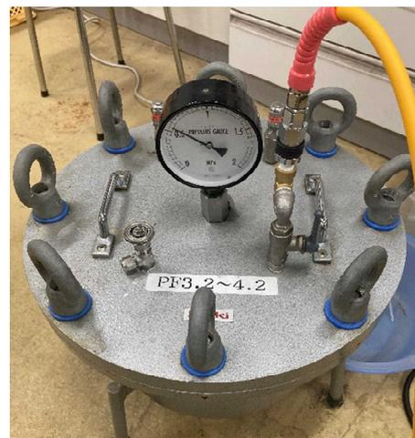
写真1 加圧式土壌 pF 測定器
