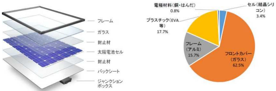
図1 太陽光パネルの構造と重量比 (1)
