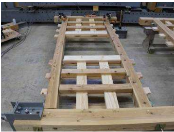
写真1 二本格子破壊後全景
