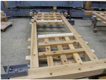
写真4 三本格子破壊後全景
