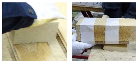
写真2 砂 (左) とビス (右) の擦り傷再現
