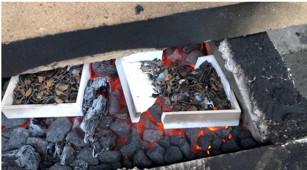
図7 卵殻の加熱処理の様子と割れてしまったるつぼ
