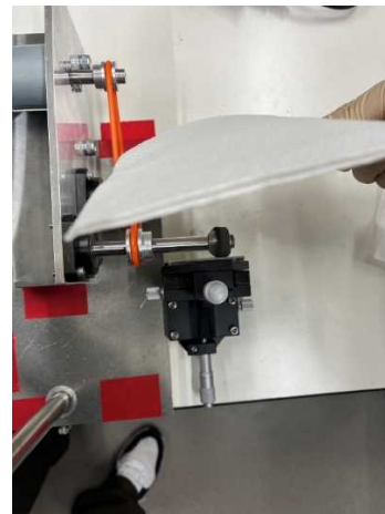
図10 疑似MRFによる研磨
