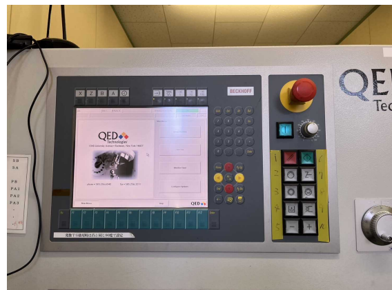
図3. MRFのプログラミングをする装置
