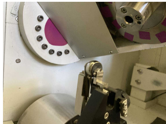
図1. MRF装置の研磨部分
