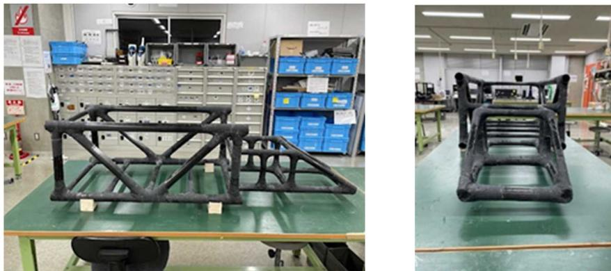
図2 完成した車体 ([左] 車体全体, [右] 車体前部)
