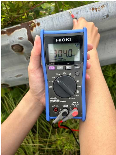
写真 2， 3 電圧を計った結果（場所により変化していることが分かる）
