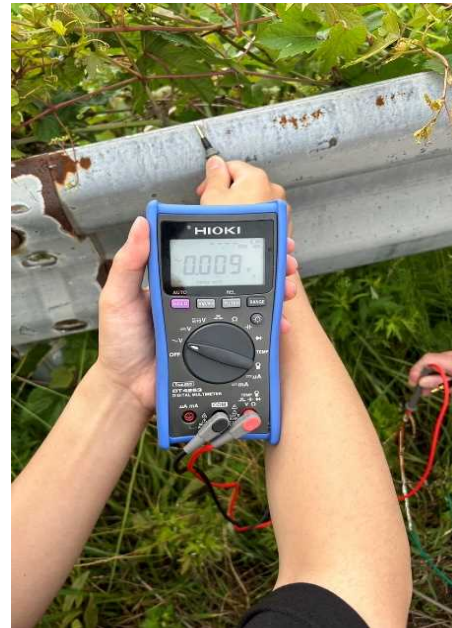
写真 2， 3 電圧を計った結果（場所により変化していることが分かる）
