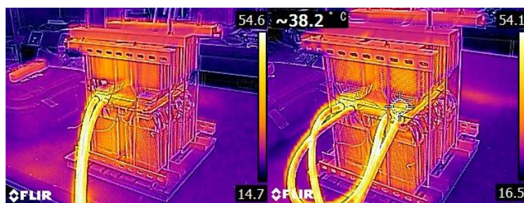
図5 60℃のときのサーモグラフィ画像
