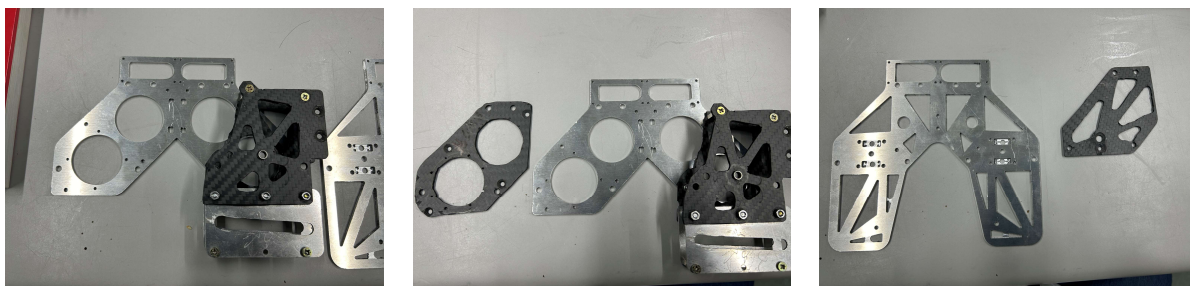
(1)内フレーム新(ジュラルミン) (2)内フレーム前(カーボン) (3)外フレーム新(ジュラルミン) 外フレーム前(カーボン)
