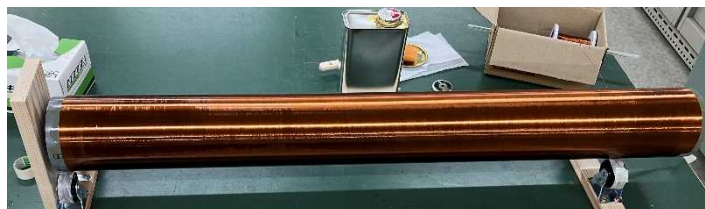
図 8 完成した二次コイル
