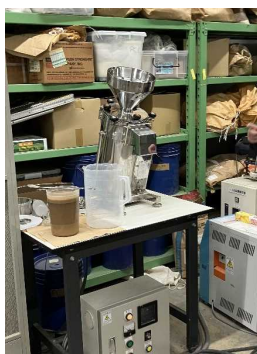
写真4：セルロースナノファイバー作成の様子
