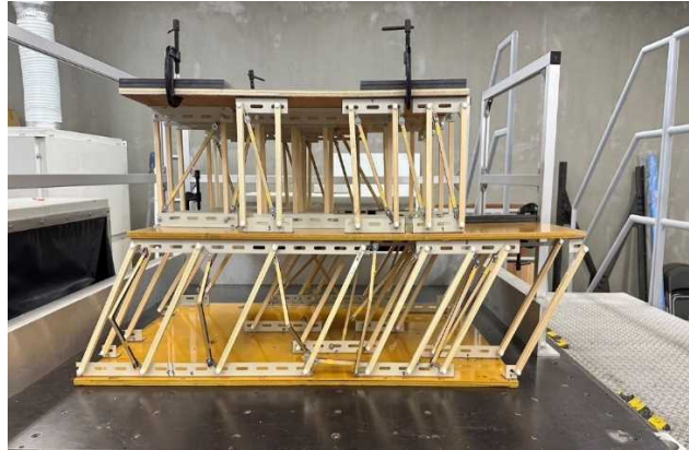
図5 加振後の TS 邸の模型写真
