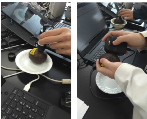
図1 可視光 (左) および近赤外光 (右) 反射率の測定の様子
