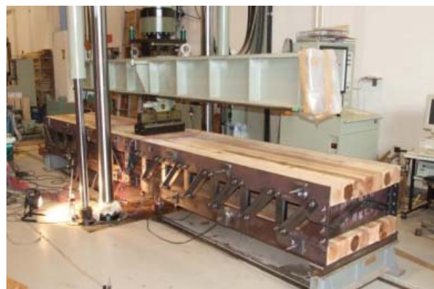
写真18 実大模型による載荷試験（形鋼タイプ）.
