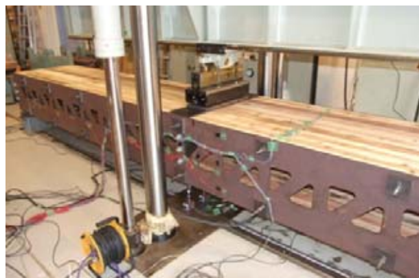
写真19 実大模型による載荷試験（鋼板タイプ）.
