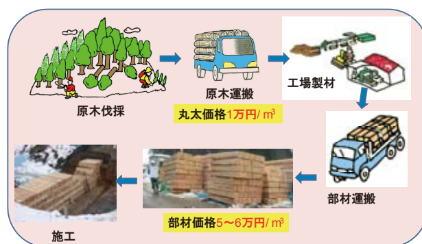
図1 通常の木製土木施設の施工。
