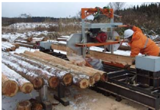
写真4 現場製材試験 (120×120mm)。
