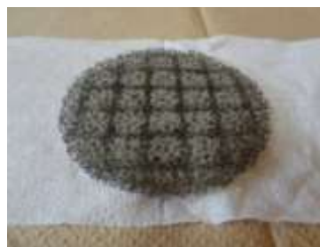
写真 8 排気口フィルターの状況 (B 邸, 台所).
