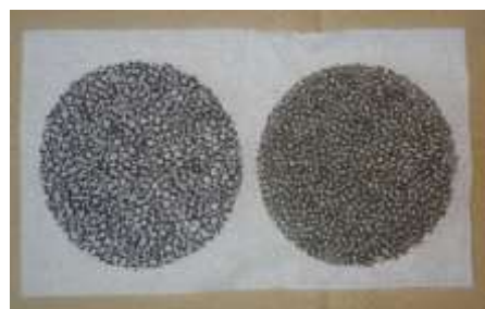
写真 9 排気口フィルターの状況 (B 邸, 台所)。 (左：新品, 右：設置済み(埃の除去後))
