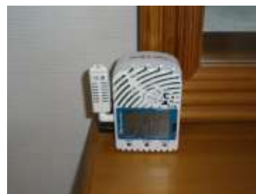
写真2 室内CO 2 濃度測定。
