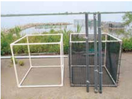
写真3-2 目合い約6mmのトリカルネットをはった食害防止枠(96×96×96cm)
