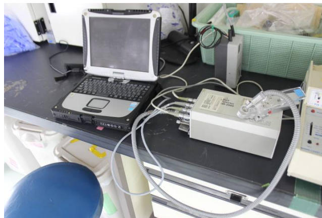
図 2-5 実験装置 (PAM, パソコン, 測定用セル)
