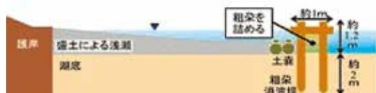
図2 2005年度に建設した植生再生地点の構造物
