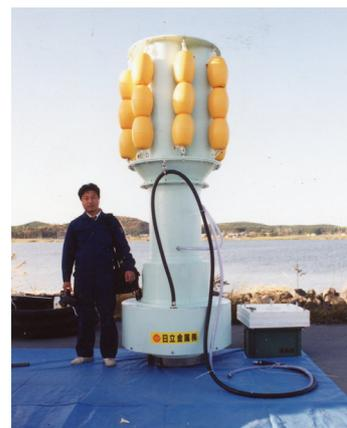
図6 間欠式空気揚水筒
