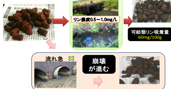
図 8 リン吸着材の現地適用 (水路浸漬法)
