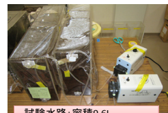
試験水路: 容積9.6L 充填ろ材: 2.4kg(体積4.8L)
