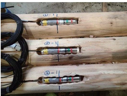
写真6 木杭への傾斜計の埋設。
