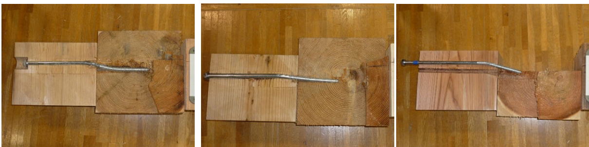
(a) 打ち込み深さ 200mm (b) 打ち込み深さ 150mm (c) 打ち込み深さ 100mm
