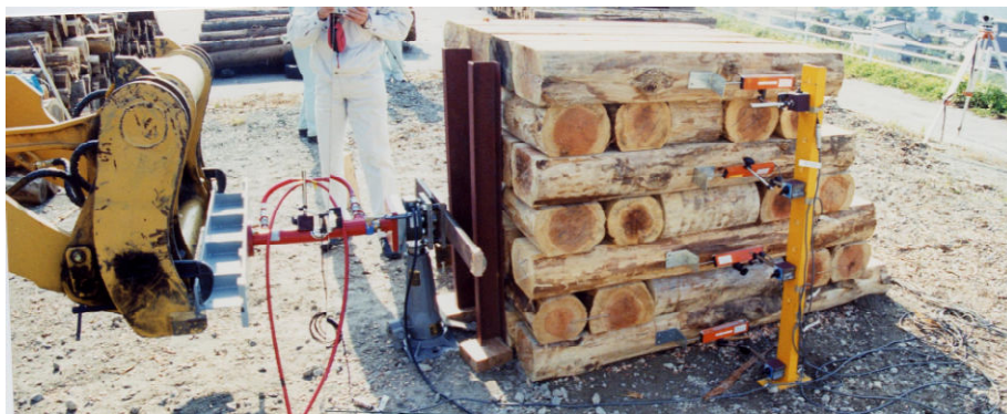
写真 1.24 水平載荷試験（杵ダム型）
