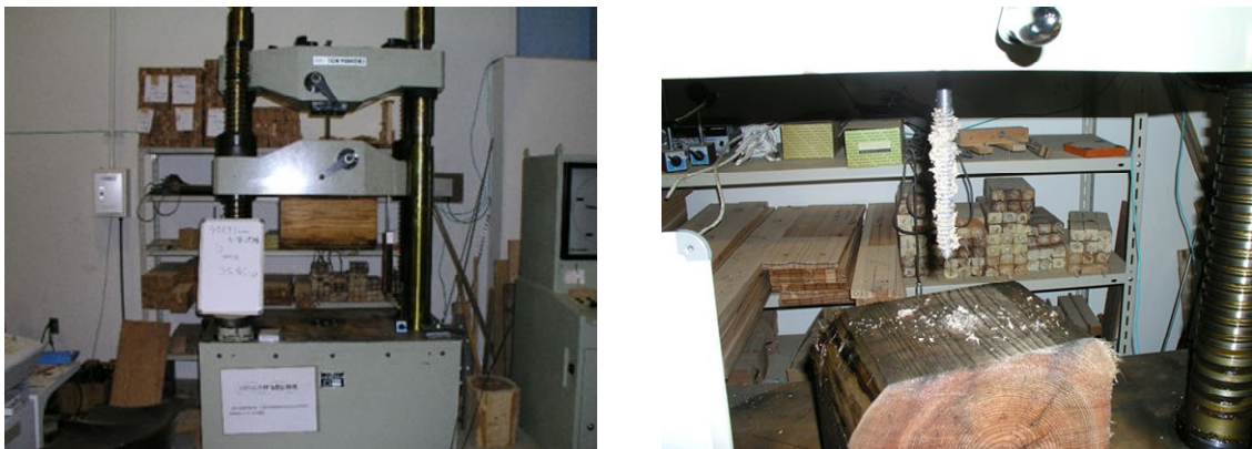
写真 1.20 引き抜き試験の状況(左)と試験後の状況(右)
