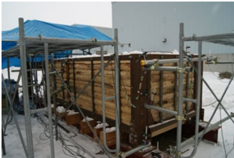
写真 1.18 水平載荷試験
