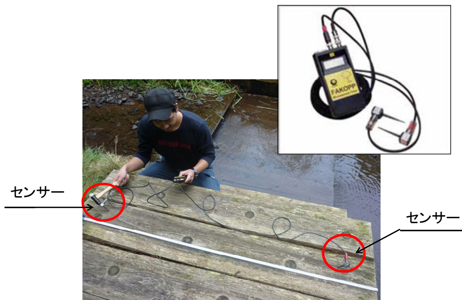
写真 3.3 応力波伝播速度測定器（FAKOPP；ファコップ）と現地計測状況
