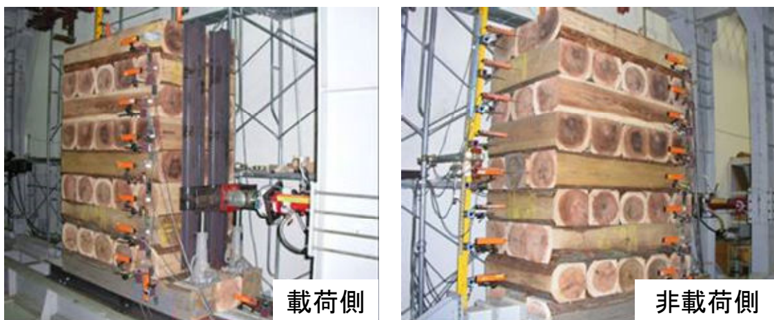
写真 1.21 堤体水平載荷試験
