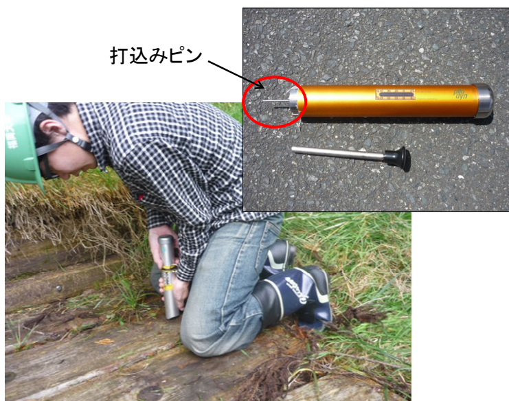
写真 3.2 ピロディンと現地計測状況
