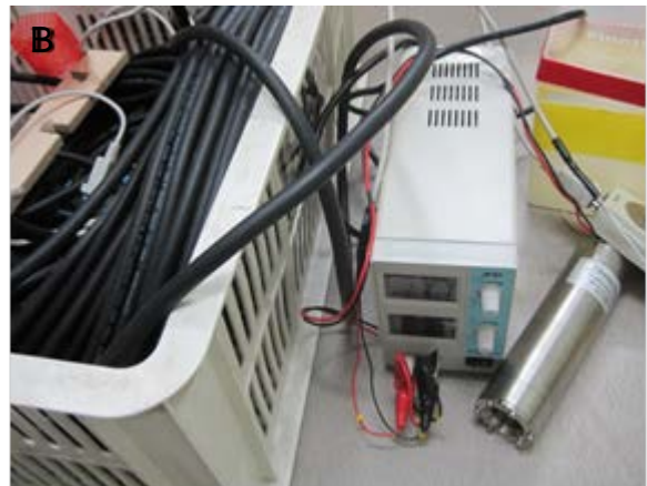
図 2-3 溶存二酸化炭素計 A: CGP-3 東亜 DKK 社、B: MET \text{CO}_2 Sensor Frana tech 社
