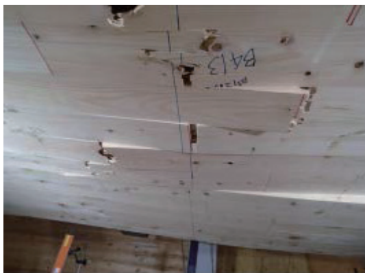
図7 曲げとせん断破壊が同時に生じた試験体
