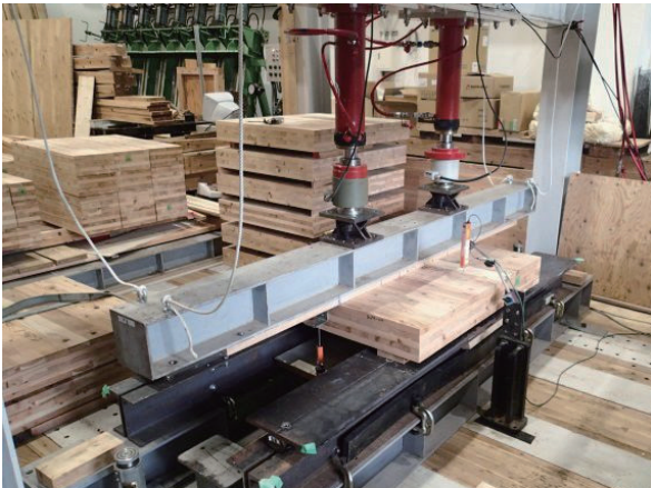
図 3 せん断試験の状況 (Sタイプ, 幅 1200mm)
