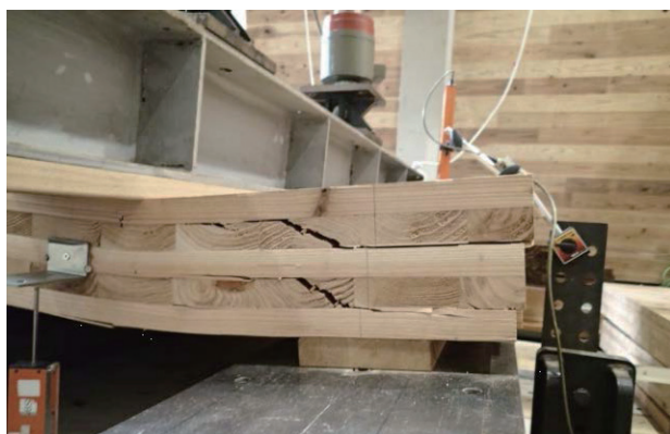
図9 せん断破壊の状況
