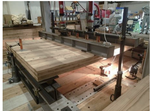
図 1 曲げ試験の状況 (S タイプ, 幅 2400mm)
