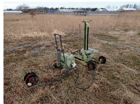
図8 試験地の地盤調査
