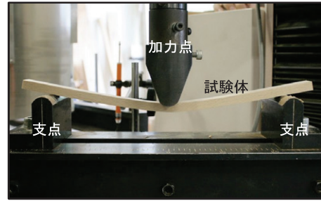
図4 スギの三点曲げ試験の様子
