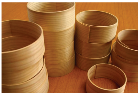
図 7 打撃音法によって選別されたスギの曲げ加工の成功
