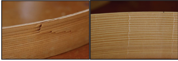
図3 曲げ加工時の木材の損傷
