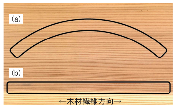
図 2 材の木取りの違い。(a)曲がった形状に切り出す、(b)切り出してから曲げる。
