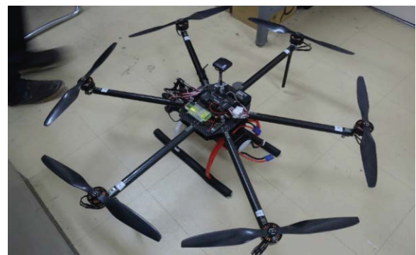
図3 製作したヘキサコプタ (Zion Pro800)
