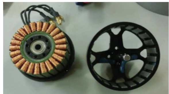
図5 ブラシレスモータ (Zion 4631-330KV)
