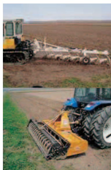
写真6 水田プラウによる耕起とバーチカルハローによる砕土作業
