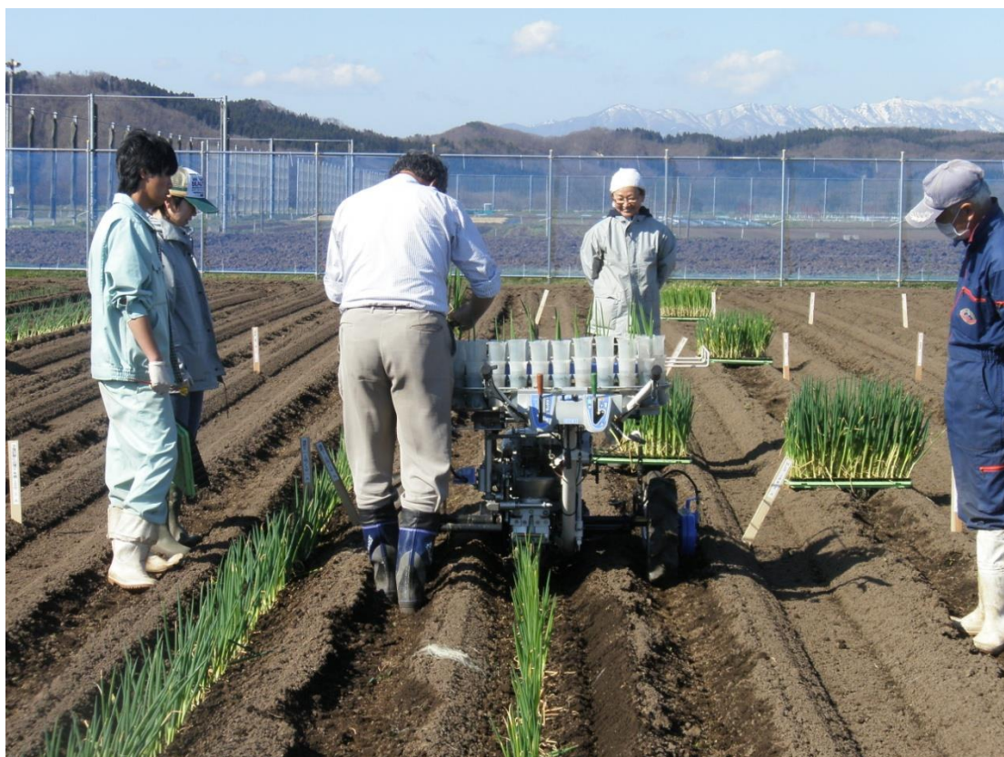
第 1-2 図 越冬育苗したセル成型苗の移植機による定植 (2009 年 4 月 17 日)
